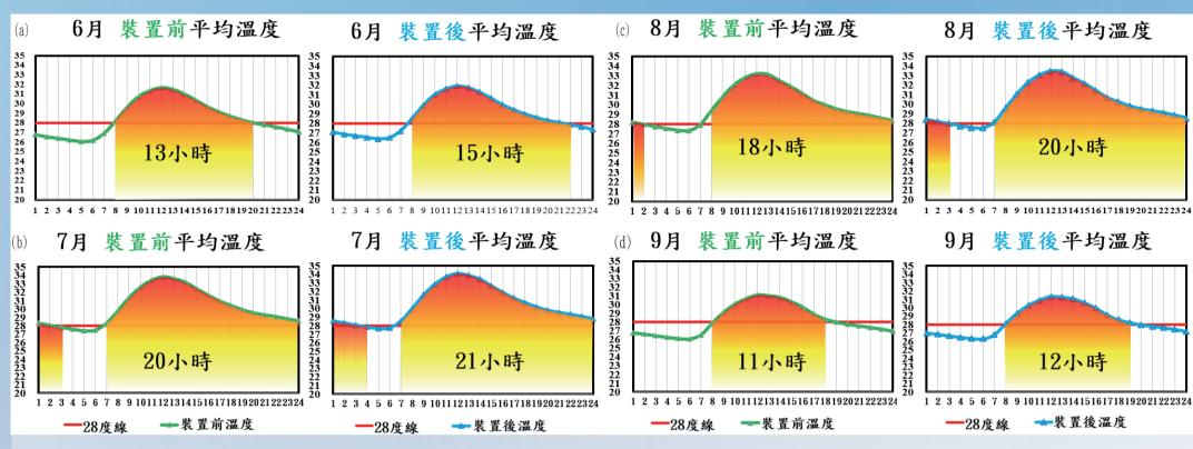
圖(四):太陽能板裝置前後之冷房度時之變化。紅線為基礎溫度28℃,綠線為裝置前之溫度日變 化,藍線為裝置太陽能板後之溫度日變化。(a)-(d)分別為6-9月。
