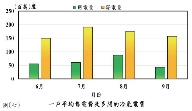
圖(六):裝置太陽能板後增 加冷氣機用電量與太陽能 板發電量,綠框為冷氣機 月用電度數, 黃框為太陽 能板月發電度數。
